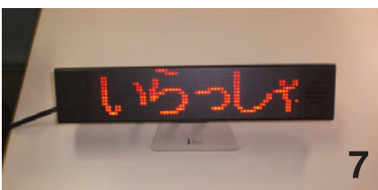
[電光掲示板] 必要な時にはいろいろな文字情報を流すことができる。緊急時にも対応できる。
